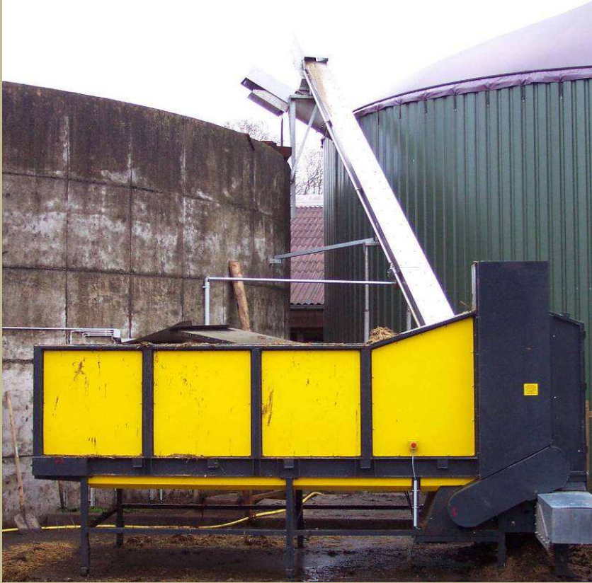
Zincir konveyörlü hidrolik katı vagon
