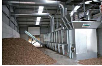
Şekil 30: İtici – karıştırıcı kurutucu / Riela 2011 /
