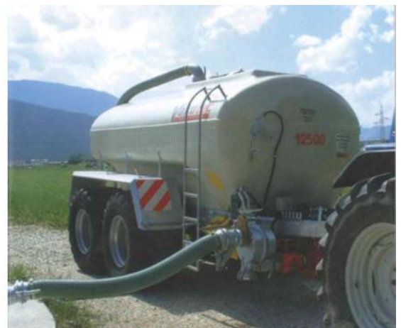
Şekil 17: Sıvı gübrenin vakumlu tankerle çekilmesi / KTBL 2006 /
