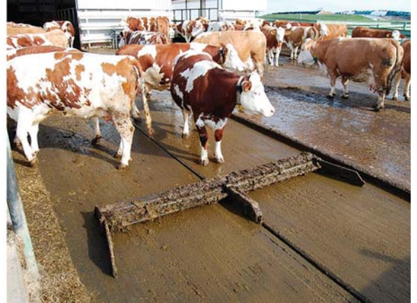
Şekil 15: Kanatlı serbest ahır gübresi sıyırma sistemi / Hau 2011 /
